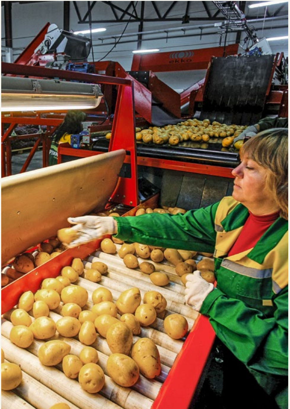
Im Packbetrieb werden die Kartoffeln gewaschen und poliert, dann getrocknet und anschließend von optisch-elektronischen Sortiermaschinen verlesen.
