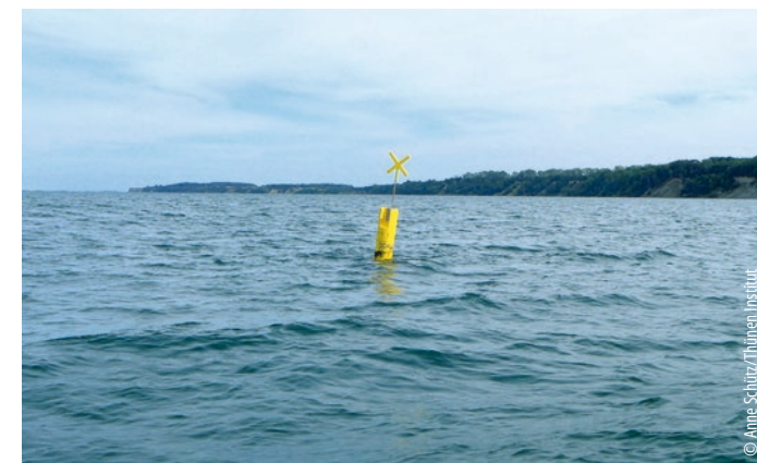
Wissenschaftliche Messgeräte, z. B. zur Messung von Wassertemperatur und Salzgehalt, sind mit gelben Kreuzbojen markiert. Es sollte Abstand gehalten werden, um die Beeinflussung der Messung zu vermeiden.
