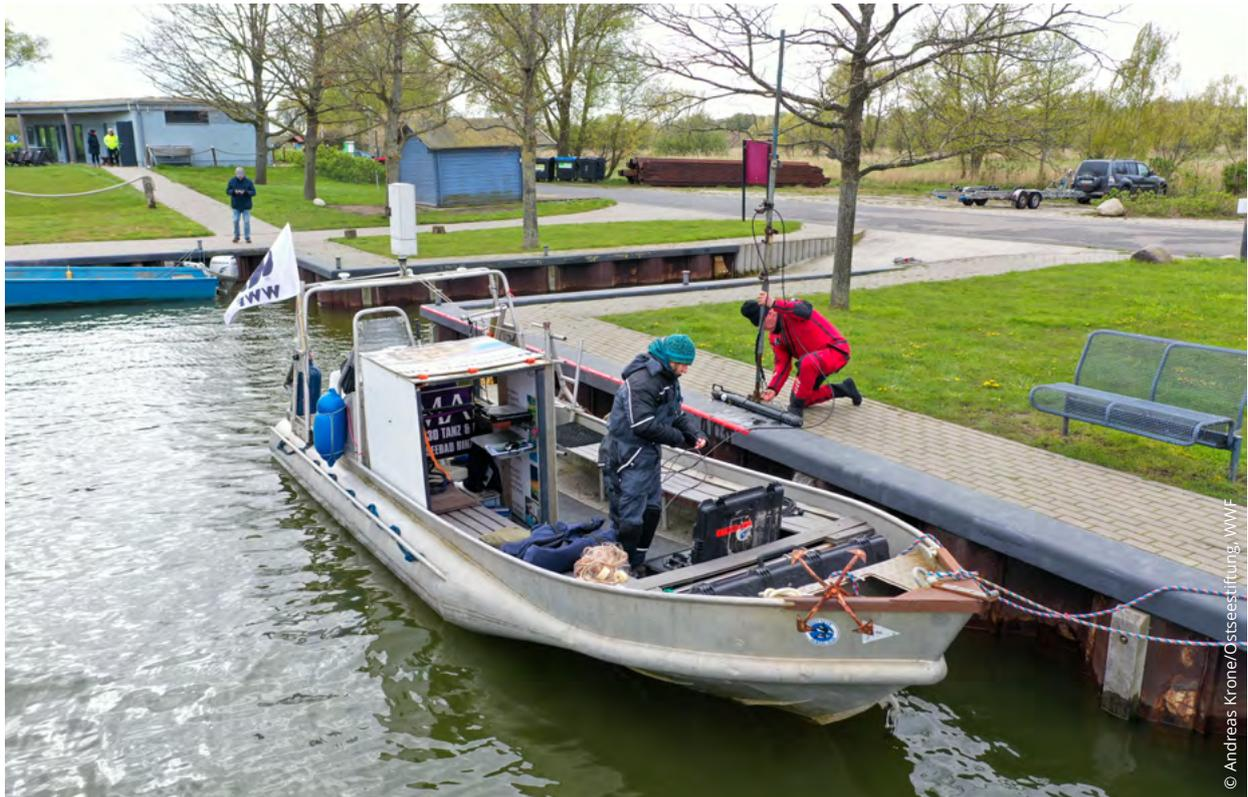
Abb. A2.1: Das Aluboot der Tauchbasis Prora wurde für Sonarfahrten und als Taucherplattform zum Setzen von Markierungsbojen mit Hebeleinen während der Bergungseinsätze genutzt.
