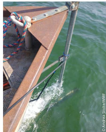
Abb. A2.2: Das Sonar kann über die hintere Umlenkrolle am Heckbügel geschleppt werden oder vorne am Bug an einer Stange fest montiert werden für die Suche in Flachwasserbereichen.
