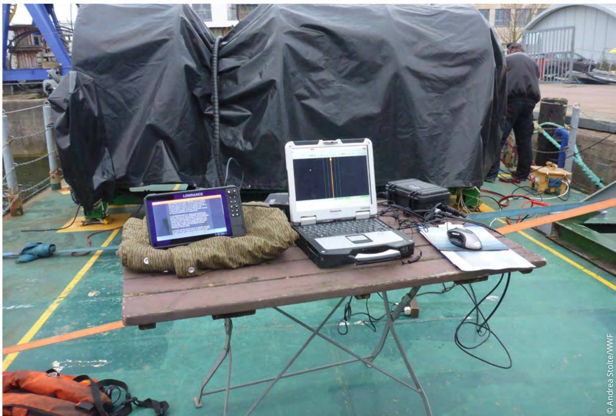
Abb. A2.7: Aufbau der Sonartechnik und GPS-Tracking auf dem Deck der „Flunder“
