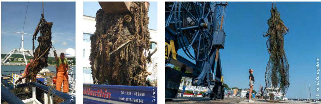
Abb. 4.11: Einholen der Schleppnetzballen auf das Deck der „Crampas“ und Entladung am Sassnitzer Hafen durch das Fuhrunternehmen Sellenthin; der Kranwagen mit Greifer am Hebekran ist für das Umladen kleinerer Netzballen ausreichend, während für das Verladen größerer Netze der Hafenkran besser geeignet ist.
