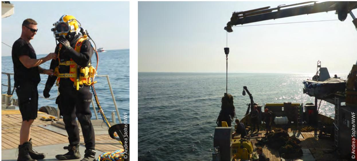
Abb. 4.12: Berufstaucher, der mit Schlauchtauch-anlage mit dem Schiff verbunden ist (links); 4-Tonnen-Hebekran der „Noorsupply“ bei einem früheren Einsatz (rechts)
