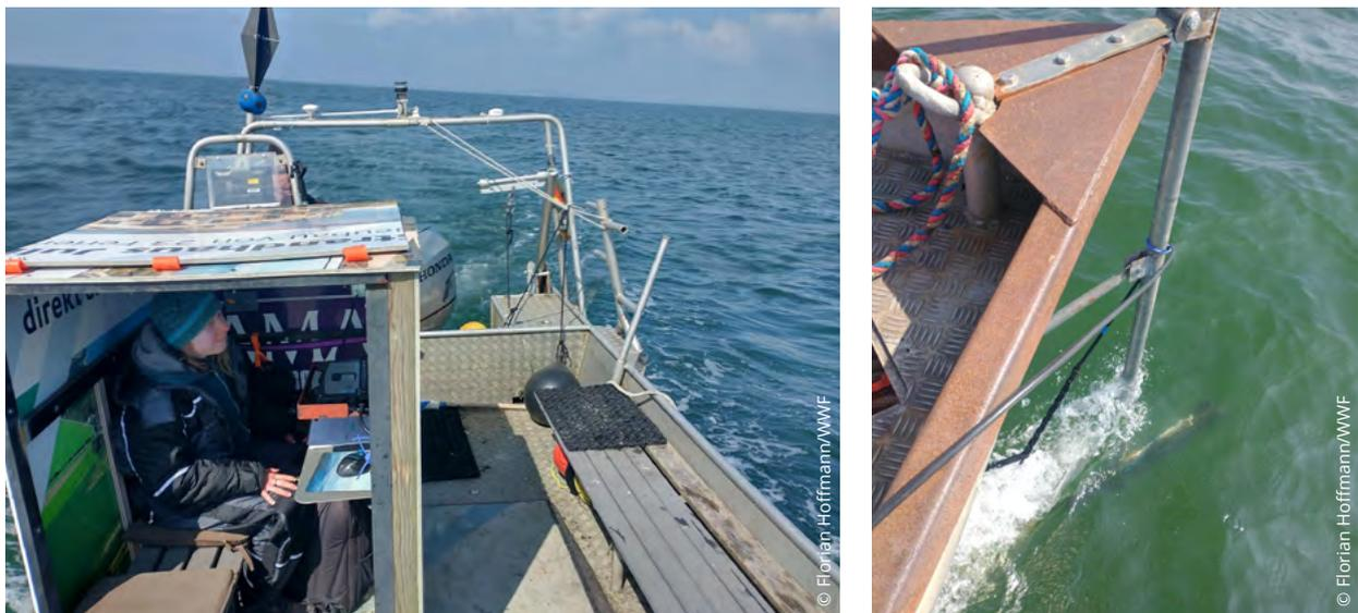
*Abb. 3.7: Sonarbeobachtung auf dem Aluboot mit Sonar über das Heck an einer Kabelrolle geschleppt (links). Sonargerät fest am Bug montiert für Sonarsuche im Flachwasser flacher als 5 m (rechts)*
