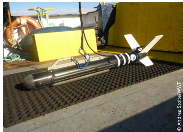
Abb. 3.3: Schleppsonar am Übertragungskabel mit der Zugwinde (links), Seitensichtsonar vom Typ ArcExplorer der Firma Marine Sonic Technology (rechts)
