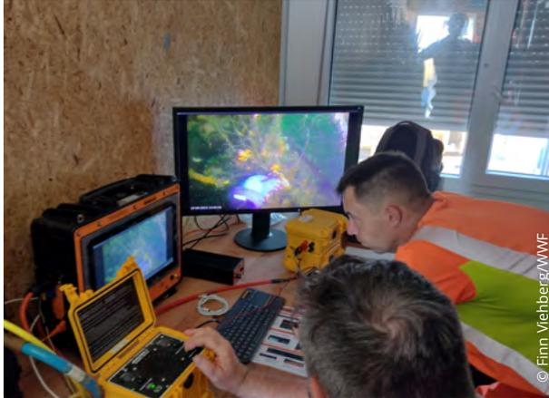
*Abb A2.16: Taucheinsatzcontainer mit Video- und Sprachlink zum aktiven Industrietaucher (links).*
