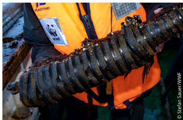
Abb. 4.10: Bergung von zwei Rolltrossen im Norden von Rügen mit der Schleppwinde des 17 m-Kutters „Crampas“, die Ummantelung der Stahlkette mit synthetischen Gummiringen ist deutlich sichtbar
