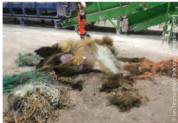
*Abb. 4.15: Aussortierte Sinkleinen mit ummantelten Bleigewichten, die dem Metallrecycling zugeführt werden (links), sowie verschiedene aussortierte Abfallfraktionen*
