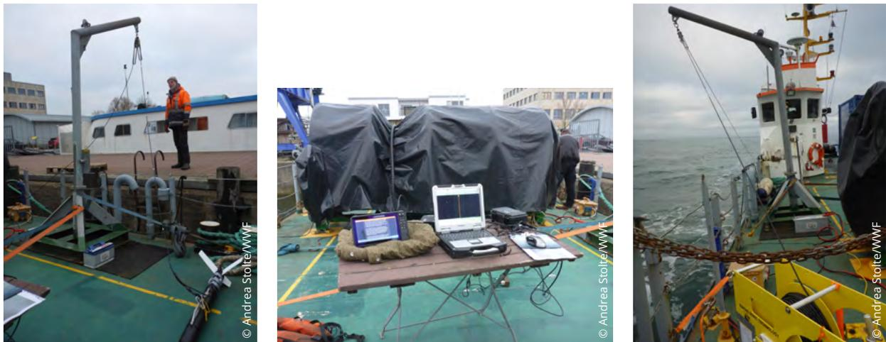
Abb. 3.5: Sonargerät (links) und Technik (Mitte) auf der „Flunder“ sowie Sonar an der Winde über den Galgen ins Wasser geführt (rechts)
