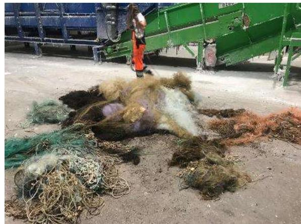
Abb. 4.15: Aussortierte Sinkleinen mit ummantelten Bleigewichten, die dem Metallrecycling zugeführt werden (links), sowie verschiedene aussortierte Abfallfraktionen.
