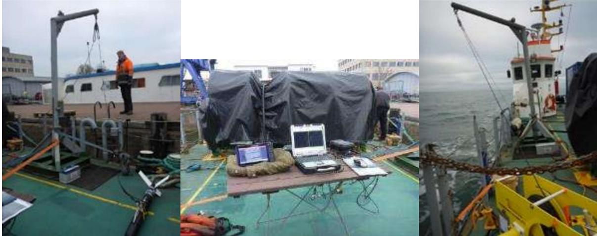
*Abb. 3.5: Sonargerät (links) und Technik (Mitte) auf der „Flunder“ sowie Sonar an der Winde über den Galgen ins Wasser geführt (rechts). © Andrea Stolte, WWF*
