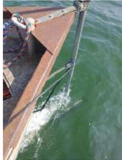
*Abb. A2.2: Das Sonar kann über die hintere Umlenkrolle am Heckbügel geschleppt werden (links, © Florian Hoffmann, WWF) oder vorne am Bug an einer Stange fest montiert werden für die Suche in Flachwasserbereichen (rechts, © Andrea Stolte, WWF).*
