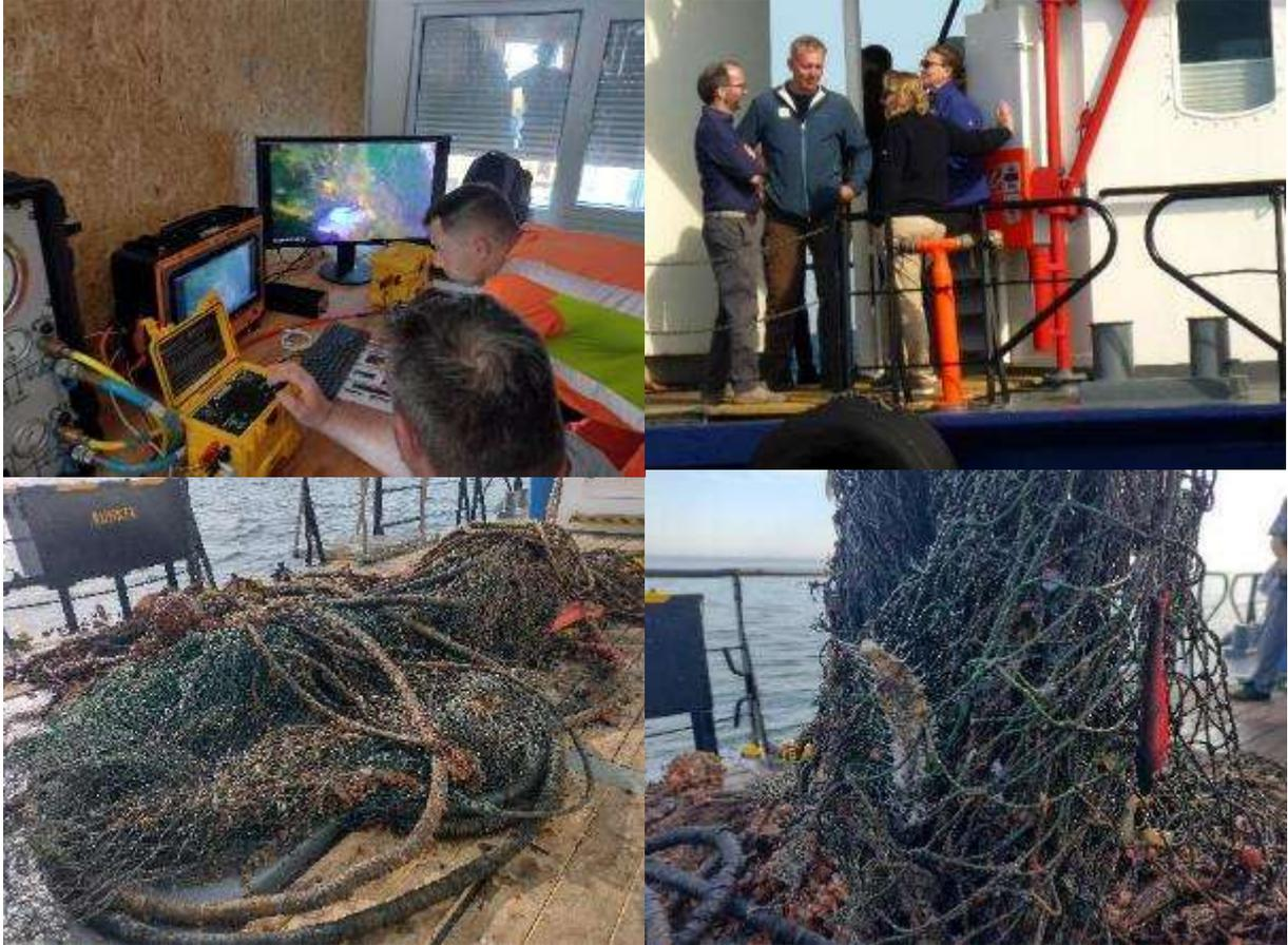
*Abb. 4.13: Bergung eines schweren Schleppnetzes mit Arbeitsschiff und Hebekran: Arbeitscontainer des Industrietauchteams mit Sprech- und Videoverbindung zum Helmtaucher (oben links), geborgenes Schleppnetz mit Zugleinen (unten links). Das mehrere Jahre alte Netz enthält Fischskelette und Angelköder (unten rechts). © Finn Viehberg, WWF*
