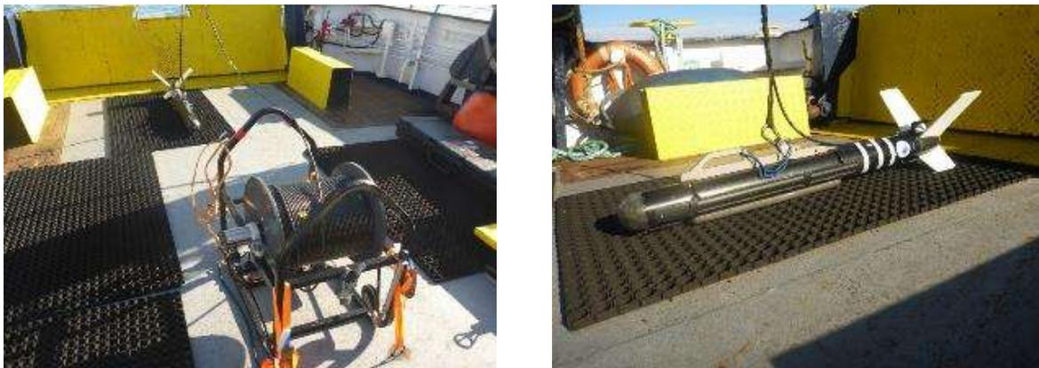
Abb. 3.3: Schleppsonar am Übertragungskabel mit der Zugwinde (links), ArcExplorer Seitensichtsonar der Firma Marine Sonic Technology (rechts). © Andrea Stolte, WWF
