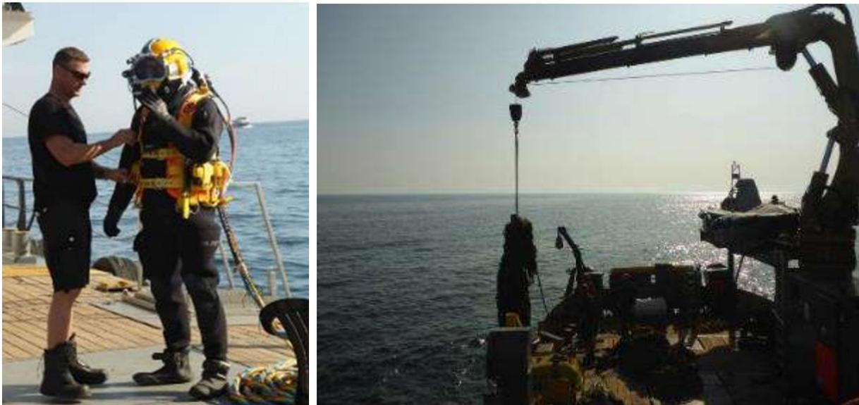
Abb. 4.12: Berufstaucher, der mit Schlauchtauchanlage mit dem Schiff verbunden ist (links). 4-Tonnen Hebekran der „Noorsupply“ bei einem früheren Einsatz (rechts). © Andrea Stolte, WWF
