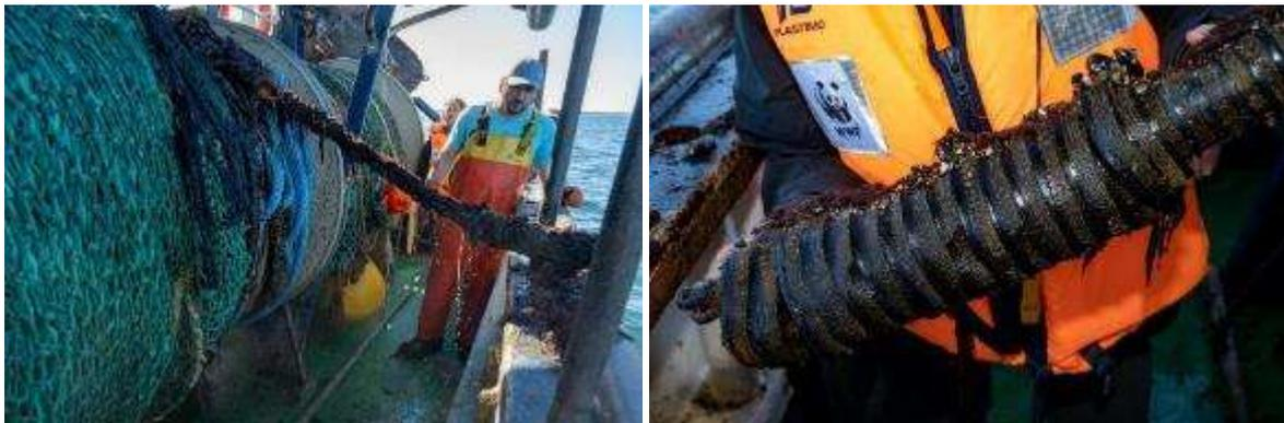
Abb. 4.10: Bergung von zwei Rolltrossen im Norden von Rügen mit der Schleppwinde des 17 m-Kutters „Crampas“, die Ummantelung der Stahlkette mit synthetischen Gummiringen ist deutlich sichtbar.
