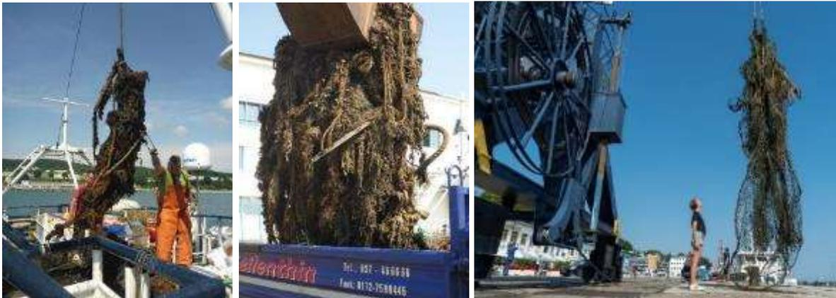
Abb. 4.11: Einholen der Schleppnetzballen auf das Deck der „Crampas“ und Entladung am Sassnitzer Hafen durch das Fuhrunternehmen Sellenthin (© Andrea Stolte, WWF). Der Kranwagen mit Greifer am Hebekran ist für das Umladen kleinerer Netzballen ausreichend (mitte), während für das Verladen größerer Netze der Hafenkran besser geeignet ist (rechts, © Uli Kunz, kunz-galerie).
